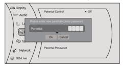
4 Enter your password with the numeric button »O« »O« »O« »O«, select »Ok« with » ▼ « and press »ENTER« to confirm.
